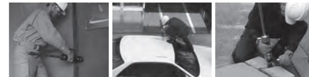
ドアノブ破壊・開錠機能 車両等の破壊救助機能 ブロック等・破壊救助機能
