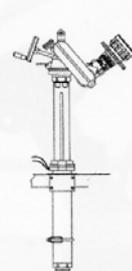
放水銃本体を消防車デッキ面から、最大300mm自由に伸ばすことが出来ます。これによりデッキ面に搭載された機材に妨げられずに自由に放水が可能になります。
